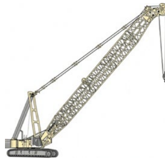
Raupenkran mit Gittermastausleger
